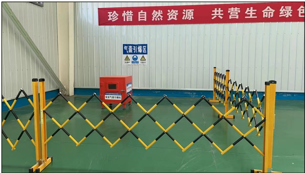
图 3-3 密闭式安全气囊引爆机照片
